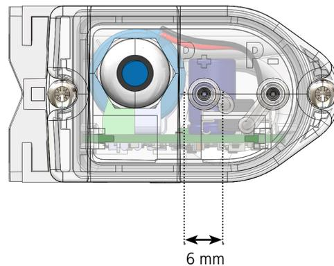
Afin d'assurer un branchement correct du produit il est nécessaire de relier le tube se positionnant là où la pression est la plus forte sur le support P+ (indiqué sur la semelle) et de relier le tube allant dans la section avec la pression la plus basse sur le support P-.
